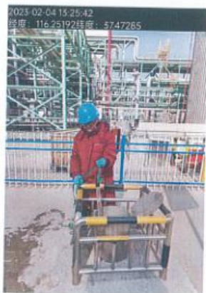
厂区 11#地下水监测井
