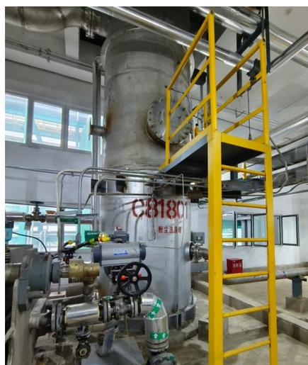
图 4.1-16 二元酸结片工序水洗塔
