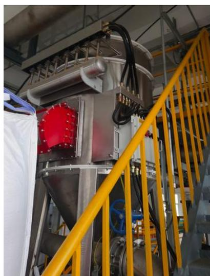
图 4.1-8 己二酸包装废气 1#布袋除尘器
